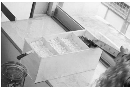
Σχήμα 8. Πειραματική συσκευή φιλτραρίσματος «κασίγαρου». Διακρίνεται το ανώτερο στρώμα θραυσμένου διατομίτη λευκού χρώματος. Εφαρμογή του κασίγαρου στο σύστημα (δεξιά).
